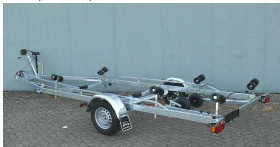
Trailers van het type LB/GT hebben een verlaagd frame met V-dwarskokers.
